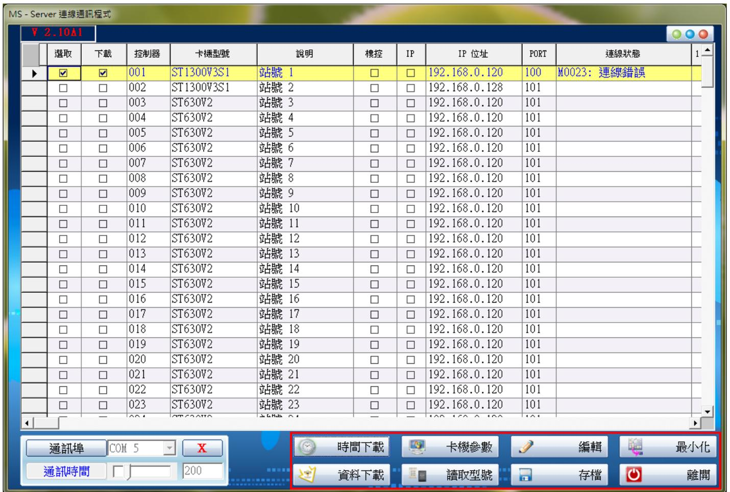
時間下載：時間校正，由電腦下載正確時間至讀卡機。
